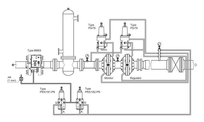
SLAM-SHUT VALVE WITH TYPE OS/80X-R-PN CONTROLLER - OVERPRESSURE AND UNDERPRESSURE CONTROL DOWNSTREAM OF REGULATORS
